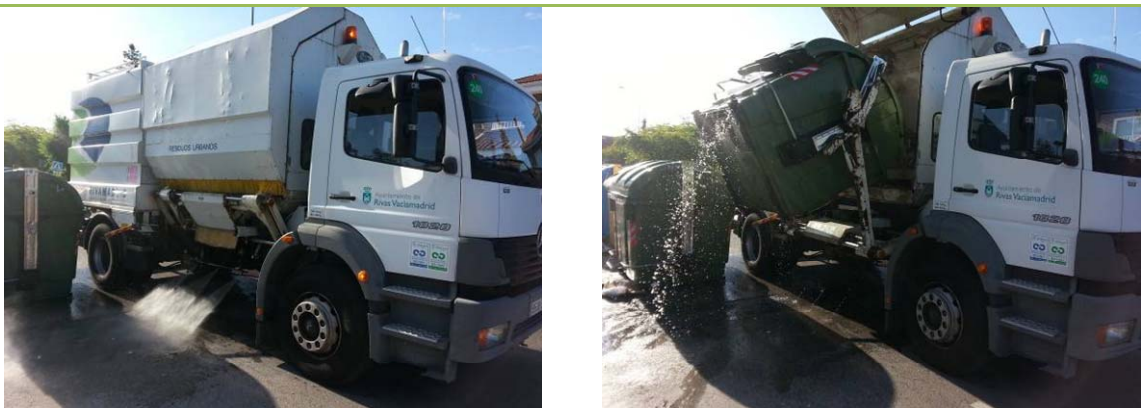
Camión lavacontenedores de carga lateral con sistema de limpieza de recintos
